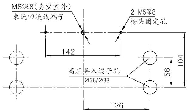
注：高压导入端子建议放在靠近真空室壁一侧，
